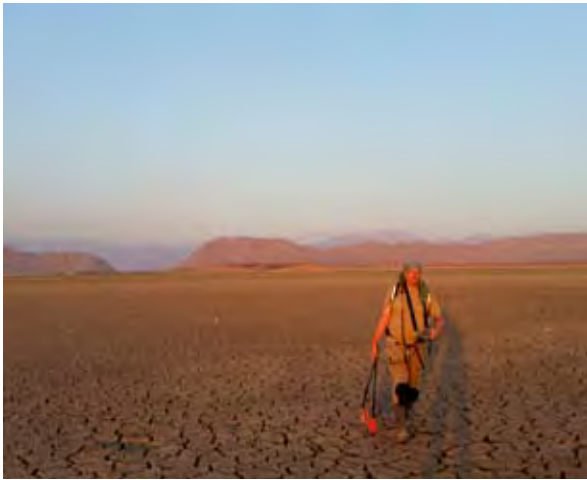
Joep Orbons metend met een EM-38 op uitgedroogde riviervlakte in Koerdistan.
